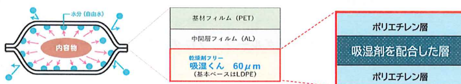
図3 「吸湿くん®」断面図例
