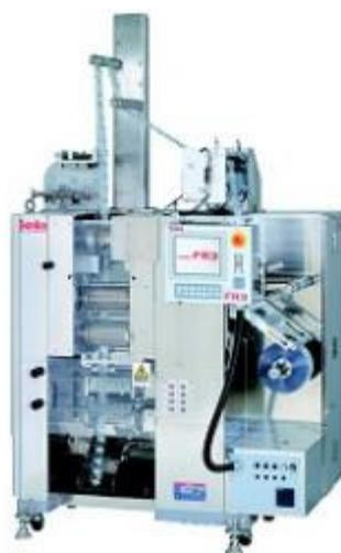
図 3. 縦型式自動充填包装機概観
